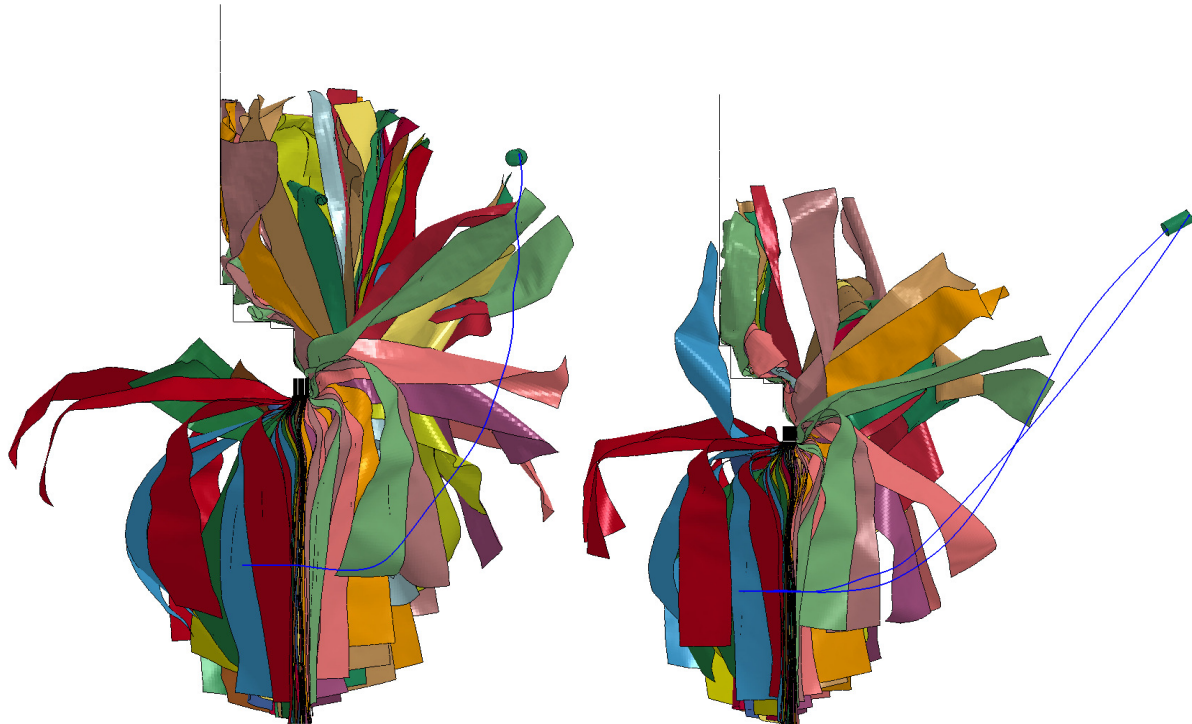
c) \mu_{LL} = 0,2 ( t = 0,06 s, v = 7,7 m/s, v_z = 0,01 m/s) d) \mu_{LL} = 0,1 ( t = 0,10 s, v = 15 m/s, v_z = 9,9 m/s) Abbildung 24a -d: Vorhangsbeschuss mit 20 Lagen, Reduzierung der Lamellenreibung von 0,4 auf 0,1
