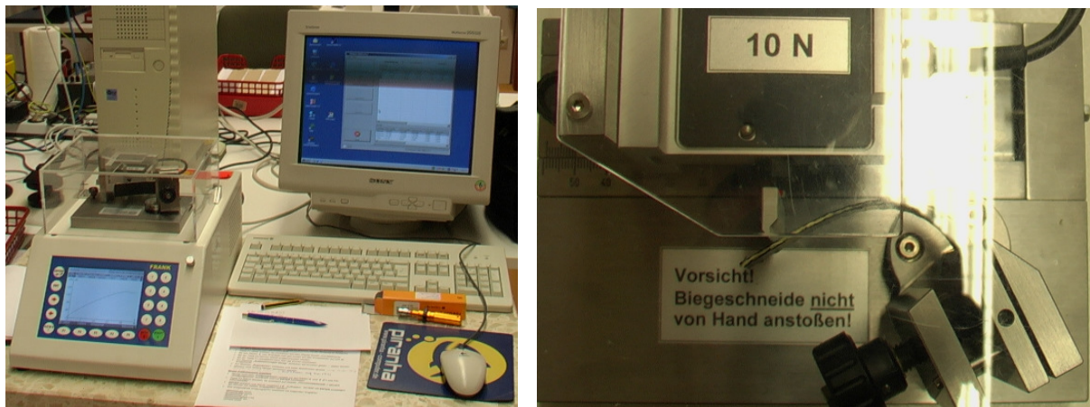
Abbildung 9: Biegesteifigkeitstest (Prüfungen nach Norm DIN 53121)
