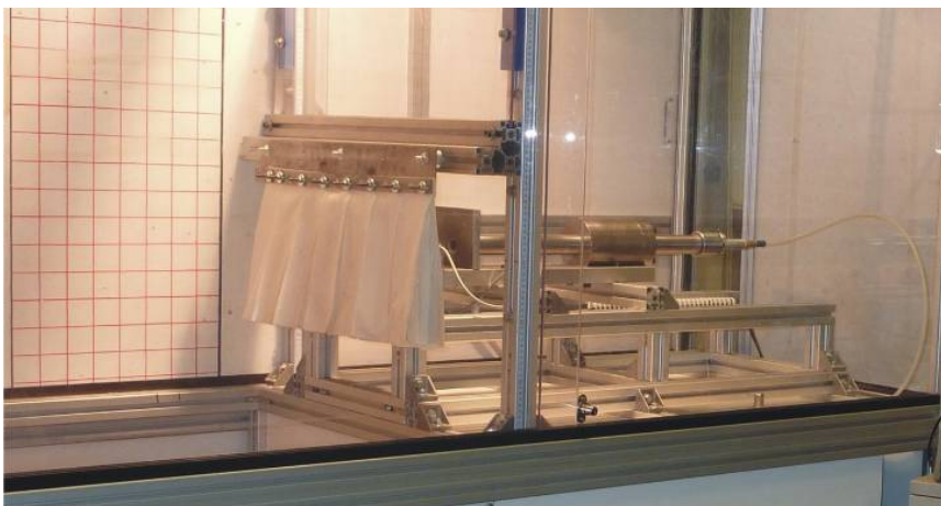
Abbildung 2: Norm-Beschussprüfstand am Institut für Werkzeugmaschinen, Universität Stuttgart
