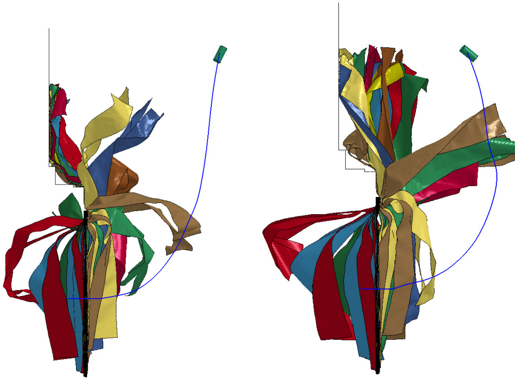
a) \mu_{LL} = 0,6 ( t = 0,04 s, v = 16,0 m/s, v_z = 2,5 m/s) b) \mu_{LL} = 1,7 ( t = 0,04 s, v = 13,6 m/s, v_z = -3,38 m/s) Abbildung 23a,b: Vorhangsbeschuss mit 10 Lagen, Material 14 mit unterschiedlicher Lamellenreibung
