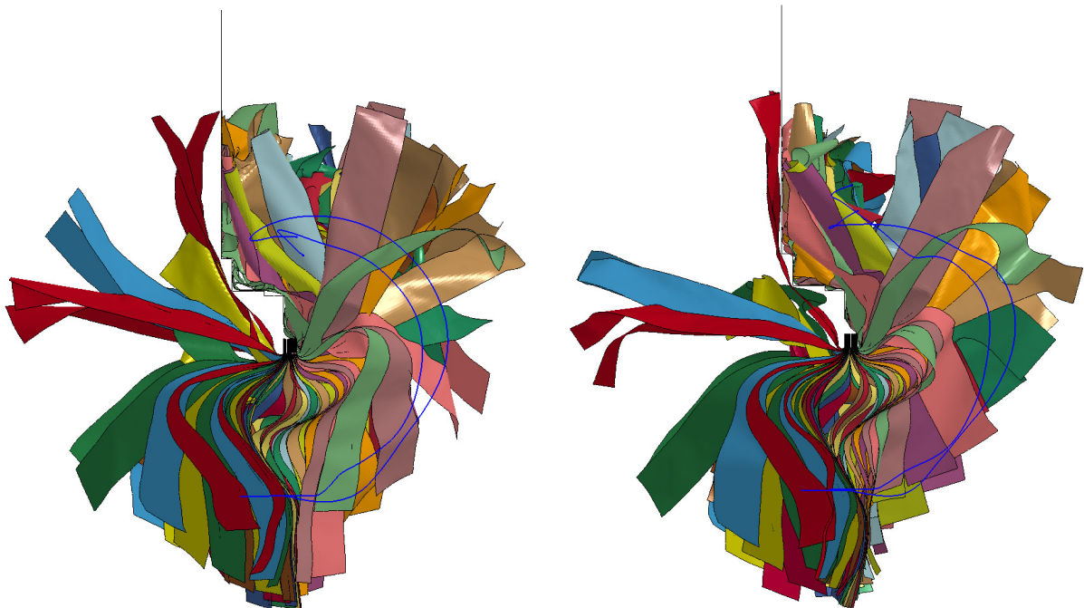
a) \mu_{LL} = 0,4 ( t = 0,12 s, v = 2,1 m/s, v_z = 2 m/s) b) \mu_{LL} = 0,3 ( t = 0,12 s, v = 2,3 m/s, v_z = 2,0 m/s)
