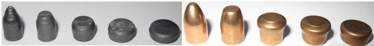
Fig. 1: Druckproben Bleikern (links) und Gesamtgeschoss (rechts)
