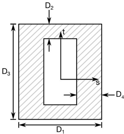
Figure 35-5. SECTION\_05 ⇒ Box-Shape
