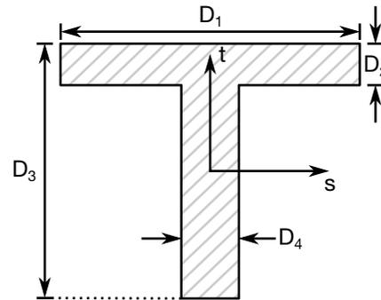
Figure 35-4. SECTION\_04 ⇒ T-Shape
