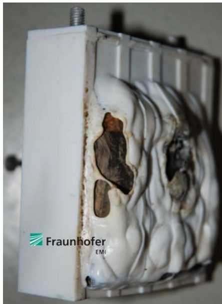
Bild 5: Primatische Li-Ionen-Zelle nach dem Nageldurchstoßversuch und exothermer elektrochemischer Reaktion aufgrund des erzwungenen Kurzschlusses
