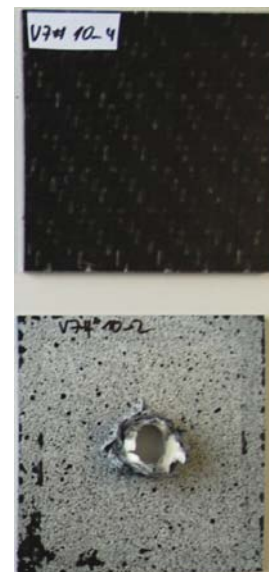
Bild 9: Grundwerkstoff PP-LGF mit einer Schicht Organoblech (V7), Probe vor und nach dem Durchstoßversuch mit DIN-EN-ISO-6603-2-Impaktor
