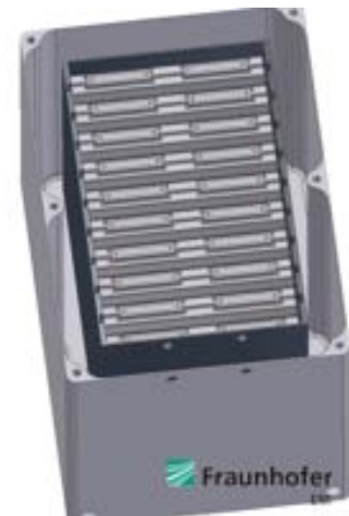
Bild 4: Entwurf eines Batteriemoduls mit Knautschzone
