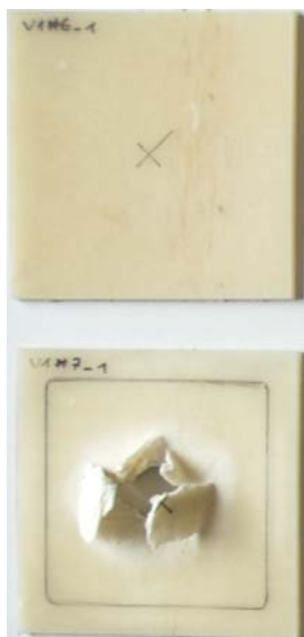
Bild 7: Grundwerkstoff PP-LGF (V1), Probe vor und nach dem Durchstoßversuch mit DIN-EN-ISO-6603-2-Impaktor
