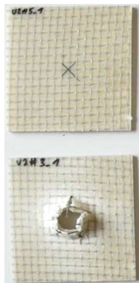
Bild 8: Grundwerkstoff PP-LGF mit eingelegtem Metallgitter (V2), Probe vor und nach dem Durchstoßversuch mit DIN-EN-ISO-6603-2-Impaktor
