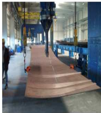
Abbildung 6 Auf dem Gesenk liegende und an 4 Ströps angeschlagene Platte
