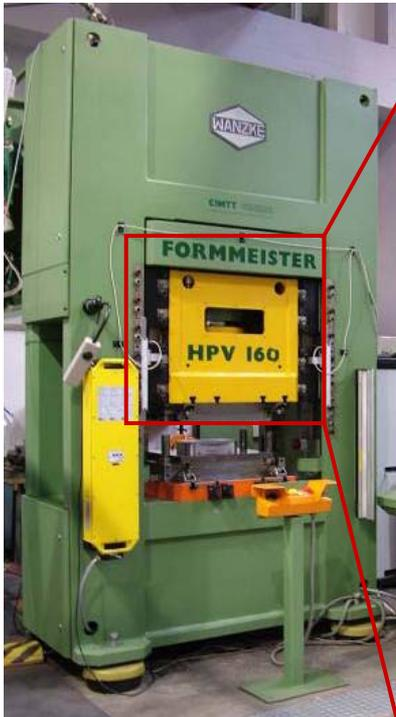
Hydraulische Presse mit 1-Punkt-Antrieb
