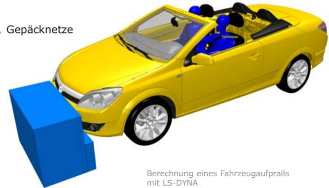
Berechnung eines Fahrzeugaufpralls mit LS-DYNA
