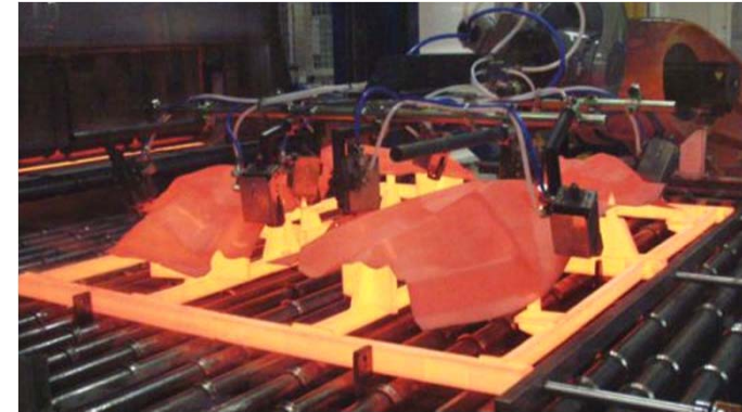
Erhitzte vorgeformte Bauteile (zweistufiges Verfahren)
