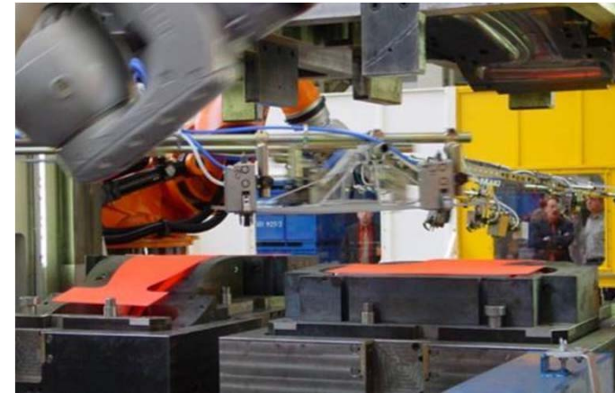
Erhitzte Platinen in die Presse (einstufiges Verfahren)
