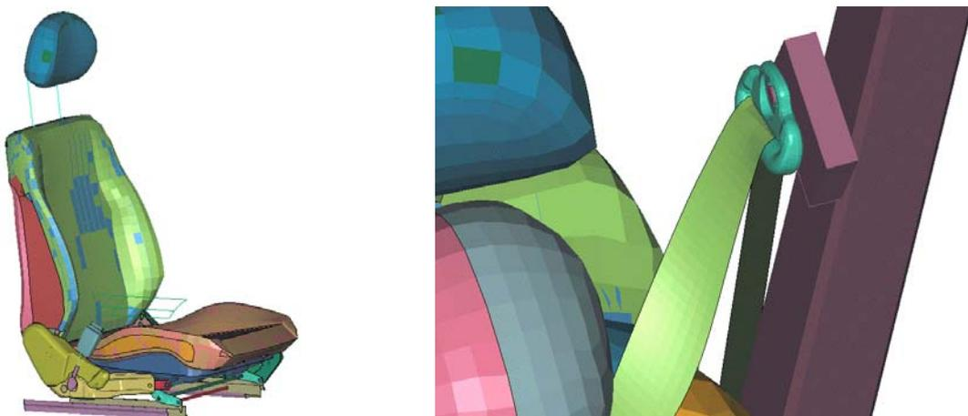
Abbildung 7 : Links das verwendete Sitzmodell. Rechts die Führung des Gurtes durch den D-Ring.
