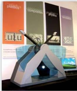
Das Pendelprüfsystem 4a Impetus kann praktisch auf einem Schreibtisch platziert und direkt in einer Entwicklungsabteilung aufgestellt werden. In der Doppelpendelausführung sind Prüfgeschwindigkeiten bis 10 m/s möglich, wobei das System nach „außen“ hin quasi impulsfrei arbeitet.
